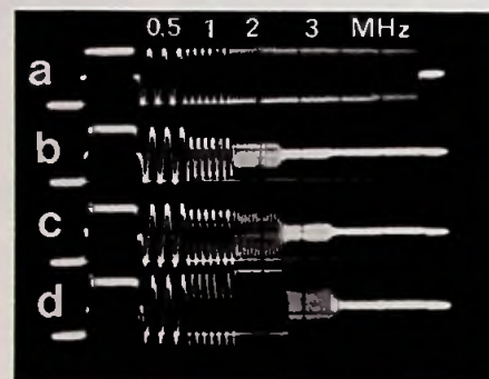
Bild 4: Video-Frequenzgänge, a) vor Band, b) über Band soft, c) normal, d) sharp
